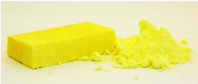
Abb. 3.1: „Gelbes Gold“: Gepresster Elementarschwefel in Barrenform und als Pulver.
