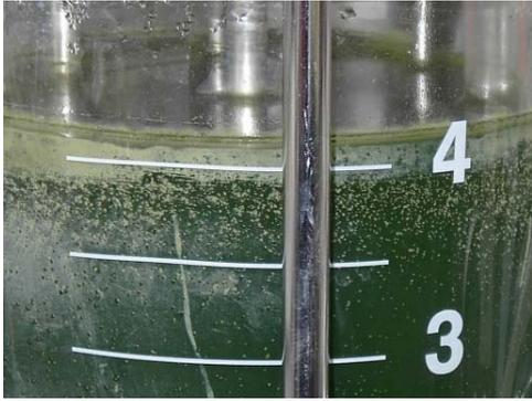
Abb. 5.23: Photobioreaktor (5 L) bei Anwendung von *P. vibrioformis* als Biokatalysator zur Produktion von biogenem  $S^0$  aus Sulfid. An der Glaswand ist der abgelagerte biogene  $S^0$  zu erkennen.
